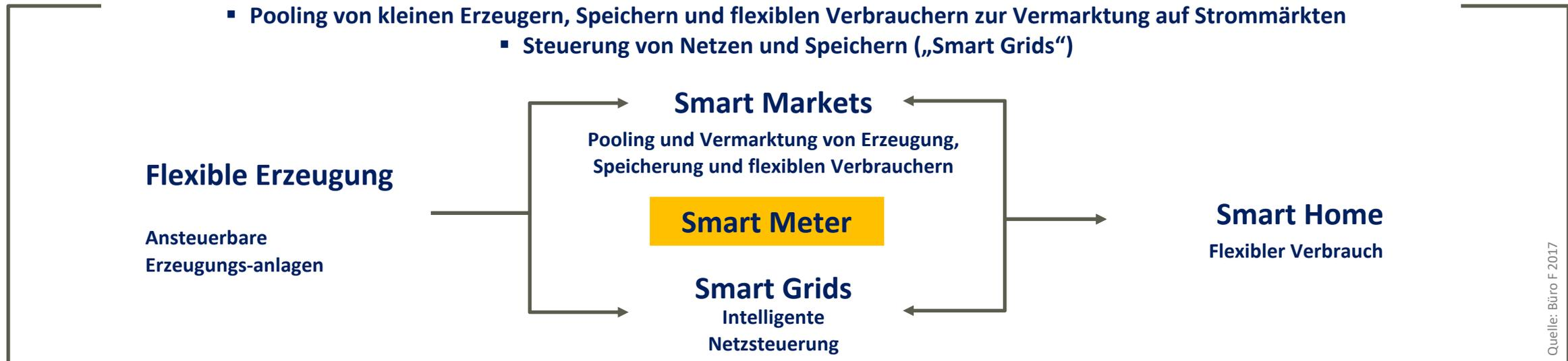
Die volatile Einspeisung aus Sonne und Wind macht ein intelligentes Energiesystem nötig. In der digitalen Verknüpfung von Erzeugung und Verbrauch liegt die Zukunft. Smart Meter stehen im Zentrum.
